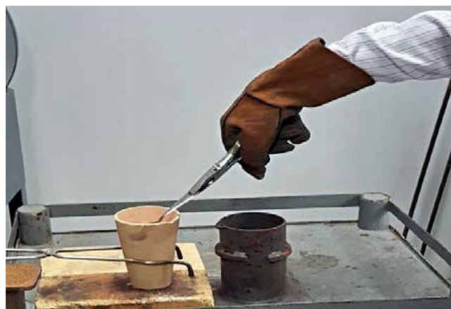
Figura 5. Remoción de impurezas del aluminio líquido. Fuente: Elaboración propia.
