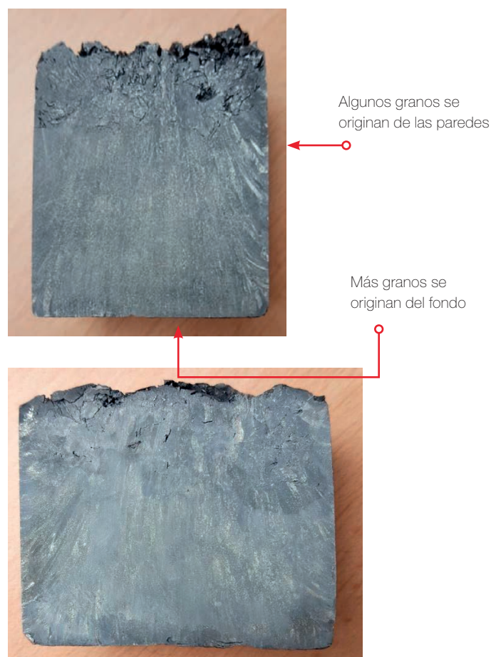
Figura 8. Fotos de las dos mitades del lingote de zinc con granos columnares después del ataque con HCl 50%. Fuente: Elaboración propia.
