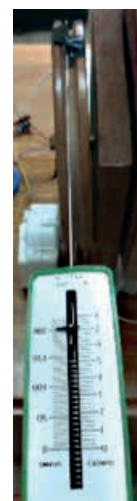
Figura 17. Medida de torque en la polea. Fuente: Elaboración propia.
