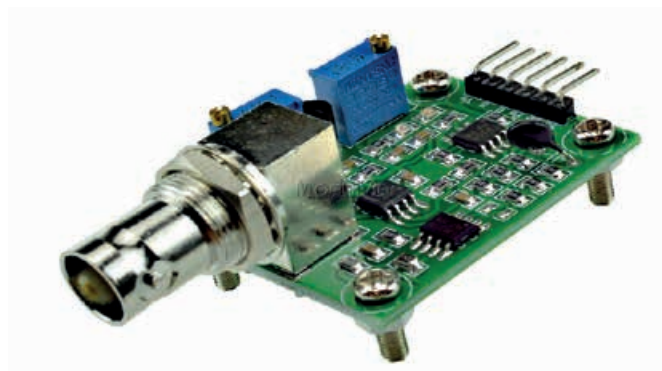
Figura 14. Interfaz del sensor de pH con conexión BNC. Fuente: Elaboración propia.
